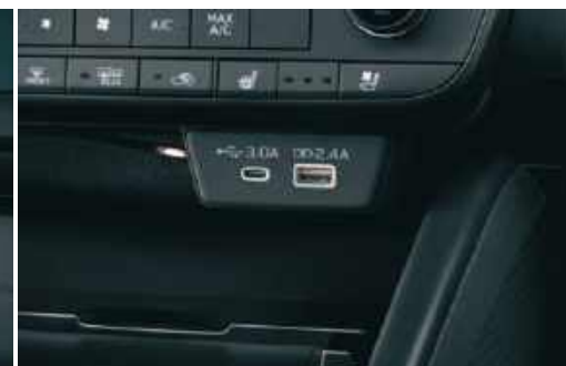
Порти живлення USB (Тип-A і C) у зоні передніх сидінь та порти живлення USB у зоні задніх сидінь
